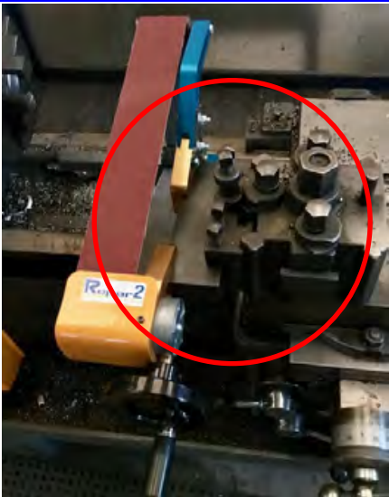
-Posizione sul carrello mobile del porta utensili della macchina. -Position on the tool post
